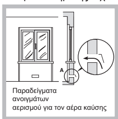
Γειτονικός χώρος Αεριζόμενος χώρος Αύξηση της εσοχής μεταξύ πόρτας και δαπέδου
