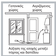
Παραδείγματα ανοιγμάτων αερισμού για τον αέρα καύσης
