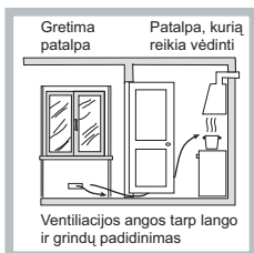
Oksidacinio oro vėdinimo angų pavyzdžiai
