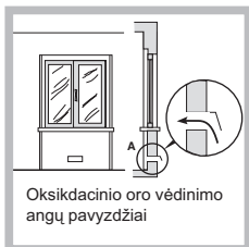
Gretima patalpa Patalpa, kurią reikia vėdinti Ventiliacijos angos tarp lango ir grindų padidinimas
