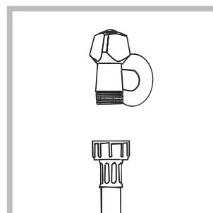
1. Pripojte prívodnú hadicu jej zaskrutkováním ku kohútiku so studenou vodou, s hrdlom so závitom 3/4" (vid' obrázok). Pred pripojením hadice nechajte vodu odtieckať, až kým nebudete číra.
