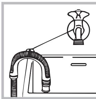
nebo ji uchyťte k okraji umývadla či vany a připevněte ji ke kohoutu prostřednictvím držáku z příslušenství (viz obrázek). Volný konec vypouštěcí hadice nesmí zůstat ponořený do vody.
