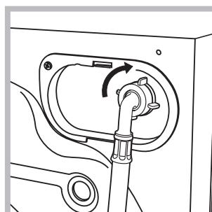
2. Ligue o tubo de alimentação na máquina de lavar e secar roupa atarraxando-o no apropriado fornecimento da água, na parte traseira, em cima à direita (veja a figura).
