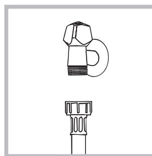
1. Schrauben Sie den Wasserschlauch an einen Kaltwasserhahn mit  $\frac{3}{4}$ -Zoll-Gewindeanschluss an (siehe Abbildung). Lassen Sie das Wasser vor dem Anschluss so lange auslaufen, bis klares Wasser austritt.
