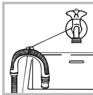
sau sprijinițil pe marginea unei chiuvete sau a unei căzi, legând elementul de ghidare la robinet (a se vedea figura). Capătul liber al furtunului de golire nu trebuie să rămână cufundat în apă.
