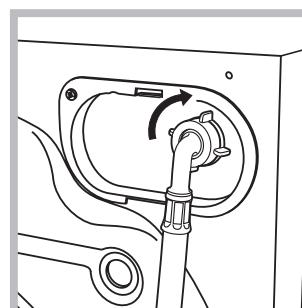
2. Conectați tubul de alimentare la mașina de spălat, însurubândul la priza de apă respectivă, amplasată în partea posterioară, sus în dreapta (a se vedea figura).
