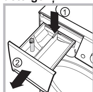
Pentru a scoate sertarul, apăsați pe levierul (1) și trageti-l spre exterior (2) (a se vedea figura). Spălați-l sub un jet de apă; această operație trebuie efectuată cât mai des posibil.
