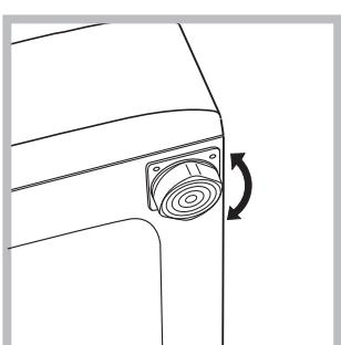
2. Se o pavimento não for perfeitamente horizontal, para compensar qualquer irregularidade, desataraxe ou ataraxe os pés dianteiros (veja a figura); ; o ângulo de inclinação, medido no plano de trabalho, não deve ultrapassar 2°.
