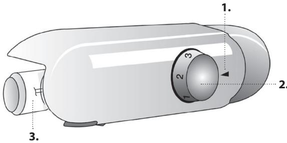
1. Referencia del control del termostato
